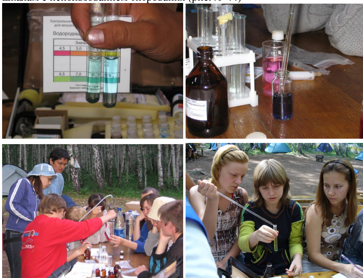
Рис.41-44. Проведение анализа качества воды при помощи портативного комплекта-лаборатории «НКВ».
