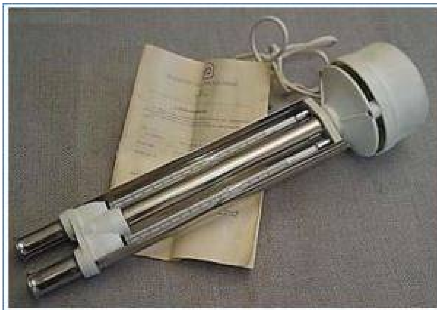
Рис. 2. Психрометр (аспирационный) Асмана
