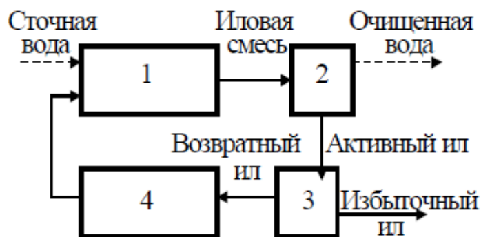
Рис. 6.11. Технологическая схема очистки сточных вод в аэротенке с регенерацией ила:
