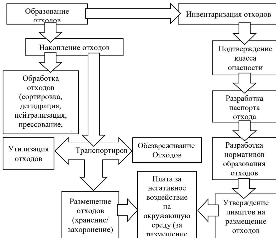
Рис.6.13. Обобщённая блок-схема обращения с отходами в организации
