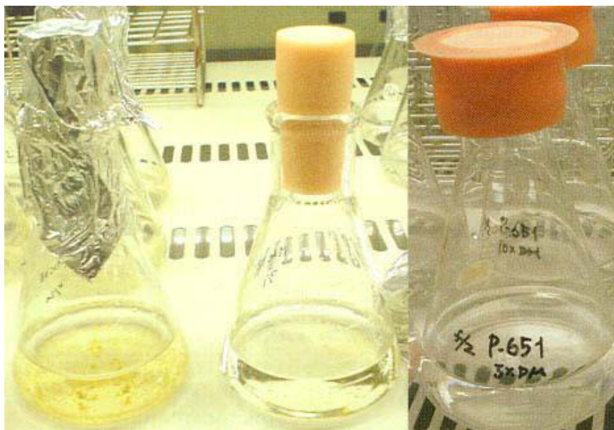
Рис. 3. Колбы Эрленмейера с силиконовыми пробками. Слева - покрытые алюминиевой фольгой; в центре - стандартная силиконовая пробка; справа - силиконовая пробка с дополнительным щитом поверх пробки (Kawachi, Noël, 2005)
