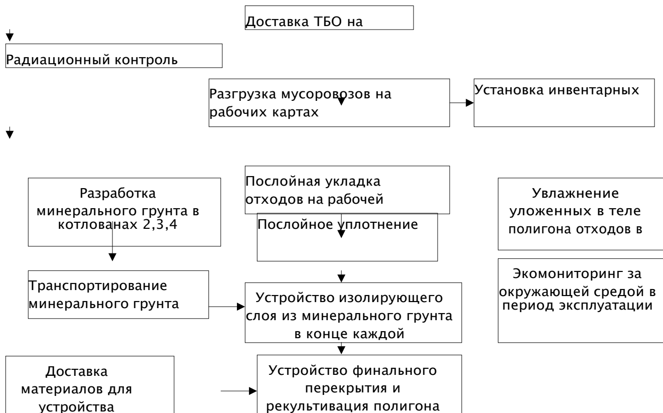
Рисунок 3. Основные операции, выполняемые при заполнении полигона отходам
