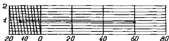
Рис. 4 Обозначение отрезка в поперечном масштабе
