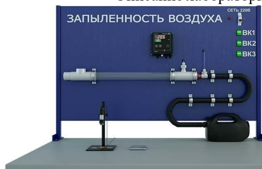
Рис.2. Лабораторный стенд «Запыленность воздуха»
