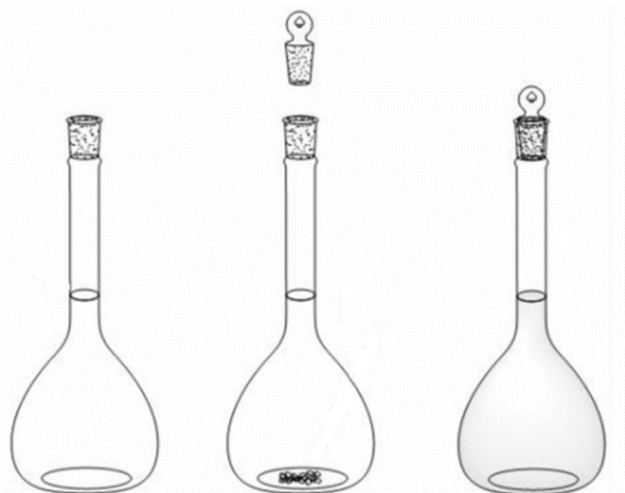
Рис. 20. Приготовление первичного стандартного раствора из кристаллического стандартного вещества
