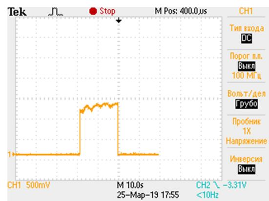
Рис.4: Сигнал резистивного переключения на полимерной пленке.  $R_3 = 300 \text{ Ом}$ ;  $R_6 = 70 \text{ кОм}$ ,  $U = 2.5 \text{ В}$ .
