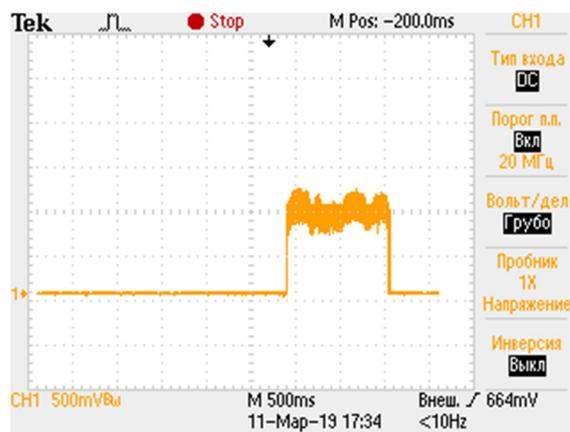
Рис.2: Сигнал резистивного переключения на полимерной пленке;  $R_3$  – 300 Ом;  $R_6$  – 30 кОм,
