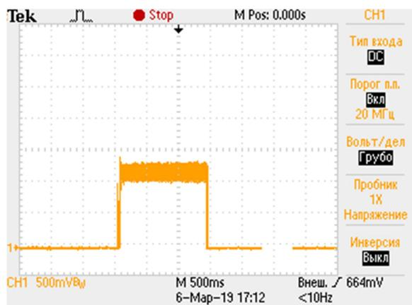
Рис. 1: Проверка экспериментальной ячейки на чистой подложке.
