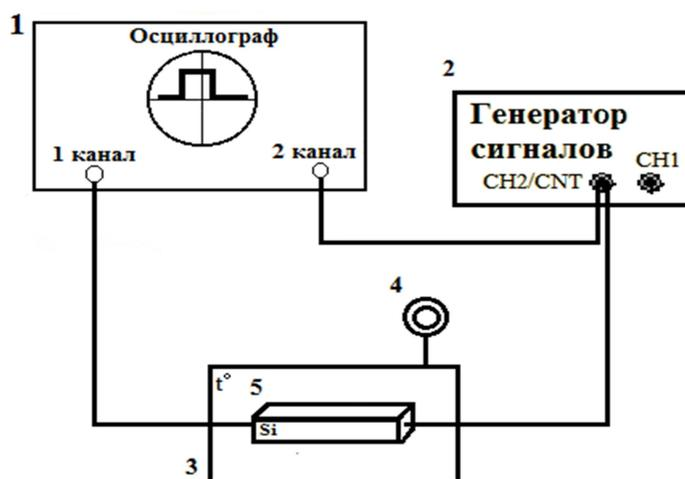
Рис.2: Измерительная установка при низких температурах: 1- осциллограф TDS 2012C; 2 – генератор сигналов специальной формы АКПП-3409/3; 3 – криостат сконтроллером температуры; 4 – вакуумный насос; 5 – кремниевая пластина 100КДБ12(100)+/-0,5.
