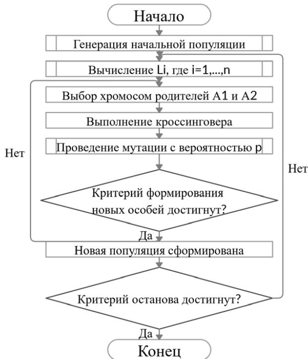
**Рис. 1 - Блок-схема генетического алгоритма**
