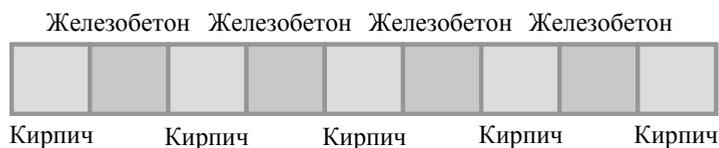
**Рис.3 - Шахматная расстановка различных конструкций**
