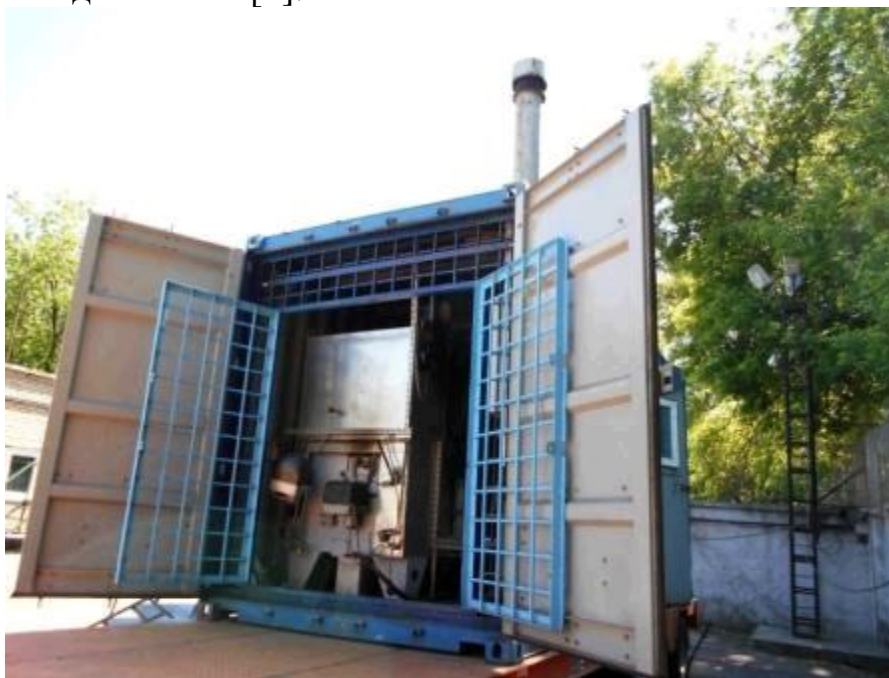
Рис. 2. Фото инсениратора ИН – 50.02.К
