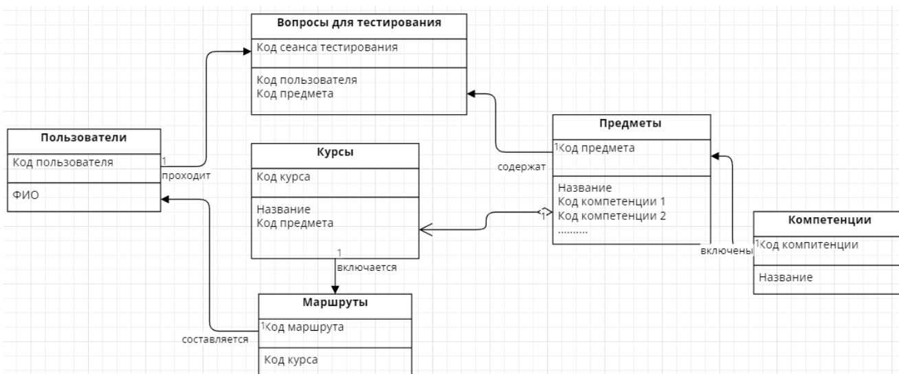
Рис. 3. Структура базы данных программы для определения уровня цифровых компетенций и составления индивидуального маршрута обучения
