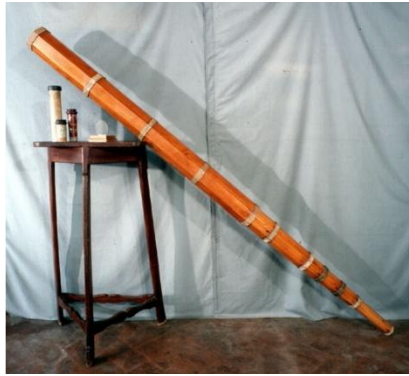
Рис. 2: Телескоп с объективом Кампани (1714 г.). Восьмигранная труба. Объектив диаметром 93 мм и фокусным расстоянием 8,2 м [3]
