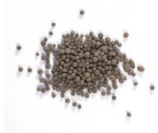
древесная гранулированная зола (размер гранул 2-4 мм)
