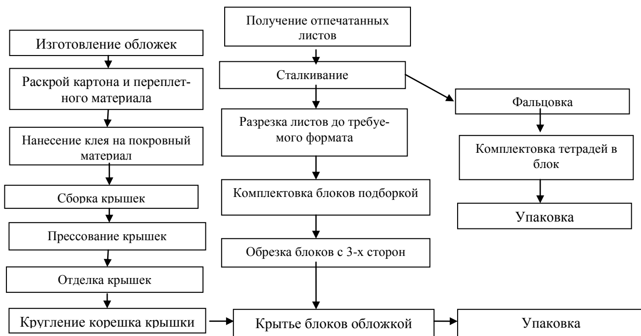
Рис.7.114. Схема технологии изготовления книги в твердом переплете
