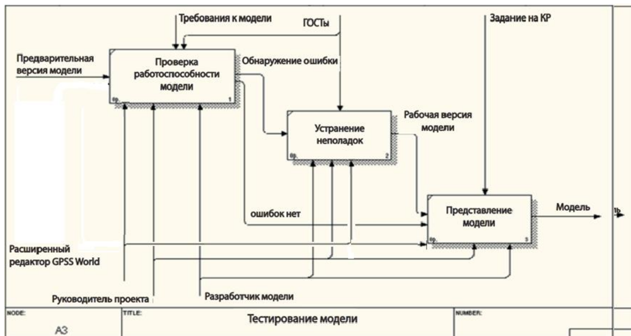
Рис.4.28. Функциональная модель второго уровня по тестированию модели – моделирование ИМПК в ПЦ
