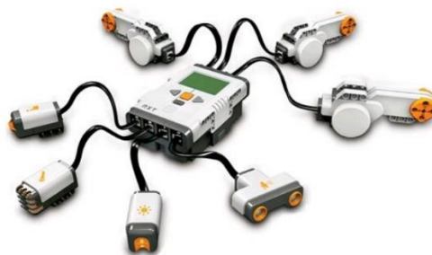
Рис. 1. Микрокомпьютер NXT с подключенными датчиками и моторами
