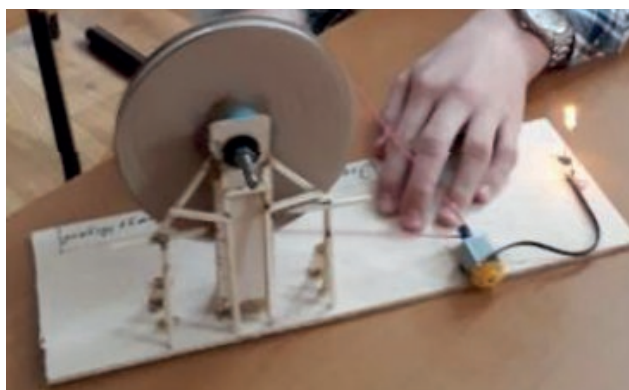
Рис. 47. Прибор для демонстрации превращения механической энергии в электрическую
