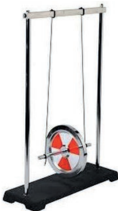
Рис. 49. Самодельный маятник Максвелла
