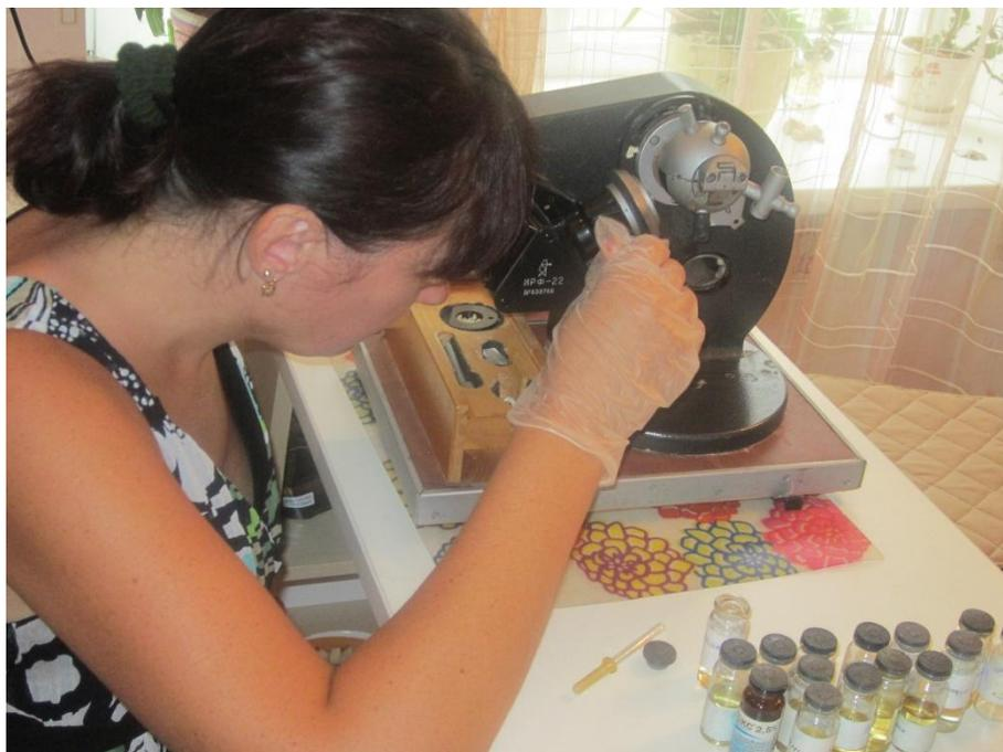
**Рисунок 3.8 - Определение содержания сахара в пробе с использованием рефрактометра ИРФ-22**
